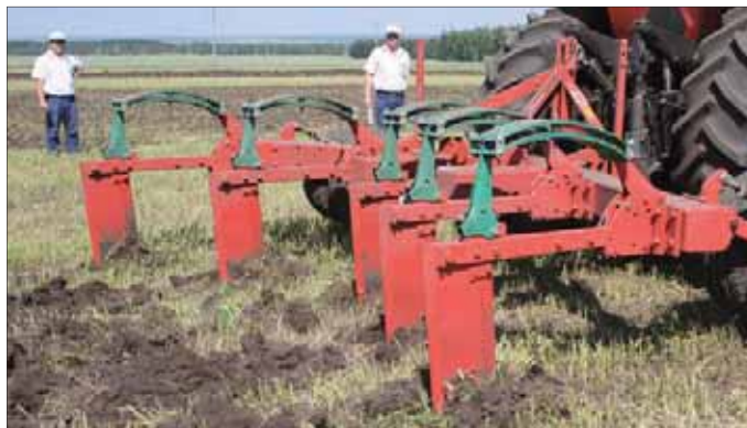
Именно этот глубококорыхлитель CLE с легкостью разрезает пласты земли. Глубина 70 см – для него не проблема. Системы рессор и усиленная V-образная рама обеспечивают надежность агрегата.
